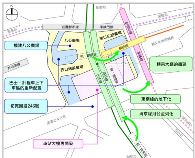
圖 4 澀谷站街區基盤整備方針 2008 整備內容概要示意圖，可看到車站設施的移設、廣場設施擴建及再開發案構想內容(資料來源：同上圖)
